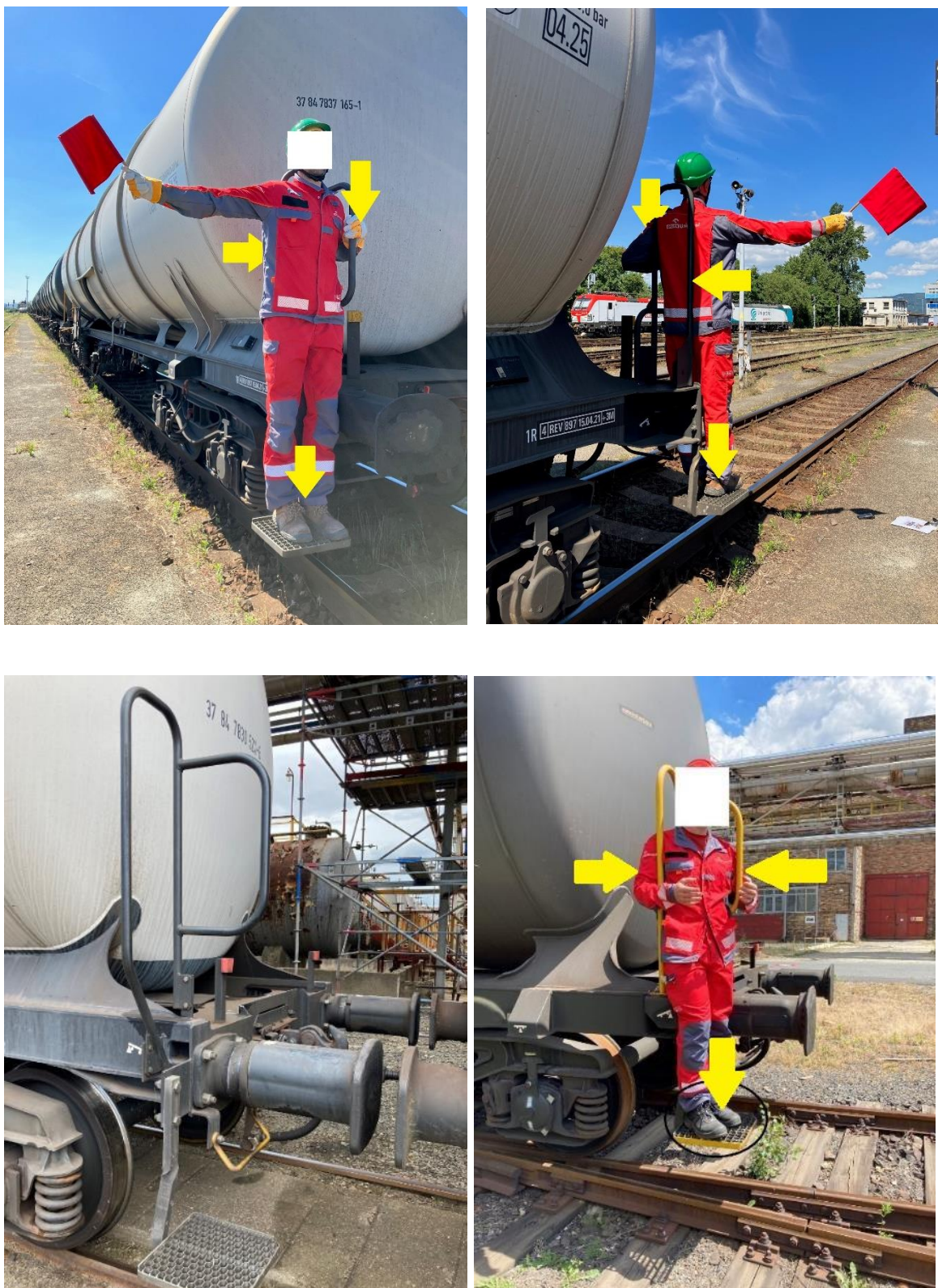
Obr. 4 – Jízda na boční stupačce s vysokými madly – šipky označují opěrná místa zaměstnance
