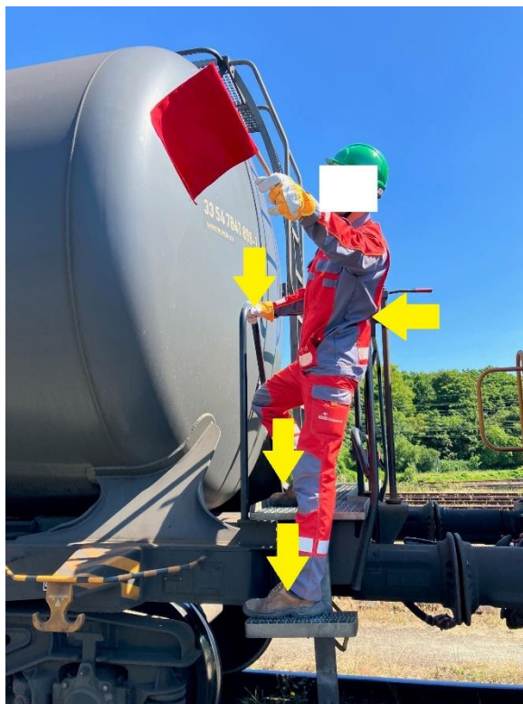
Obr. 5 – Jízda na schůdcích plošiny pro obsluhu ruční brzdy s oboustranným zábradlím – šipky označují opěrná místa zaměstnance
