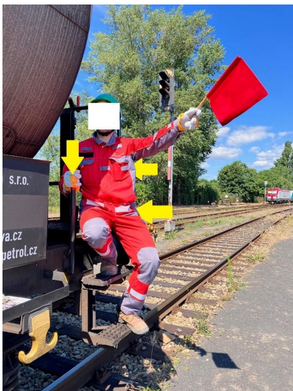
Obr. 6 – Jízda na schůdcích plošiny pro obsluhu ruční brzdy s jednostranným zábradlím a nízkým madlem – šipky označují opěrná místa zaměstnance
