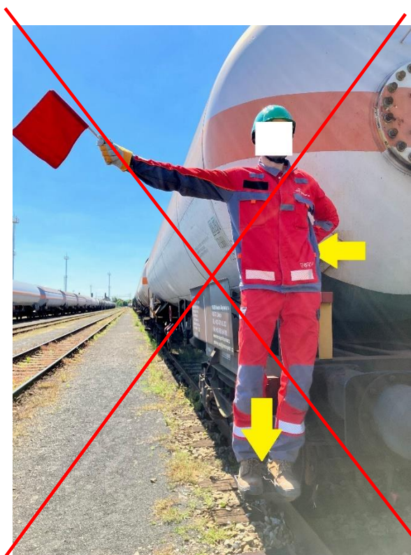
Obr. 8 – Zakázaná jízda na boční stupačce s nízkým madlem – šipky označují opěrná místa zaměstnance
