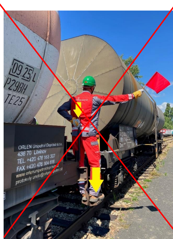
Obr. 8 – Zakázaná jízda na boční stupačce s nízkým madlem – šipky označují opěrná místa zaměstnance
