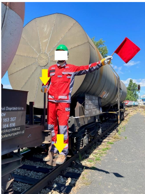
Obr. 7 – Jízda na boční stupačce s nízkým madlem – šipky označují opěrná místa zaměstnance
