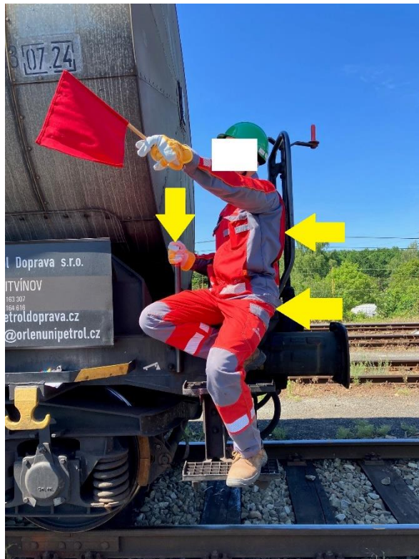
Obr. 6 – Jízda na schůdcích plošiny pro obsluhu ruční brzdy s jednostranným zábradlím a nízkým madlem – šipky označují opěrná místa zaměstnance
